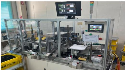
同社は組立工程においても組立作業と検査作業を一体化した自動機の開発、活用に積極的に取り組み、製造する部品の品質の安定化、製造効率化を目指している。
