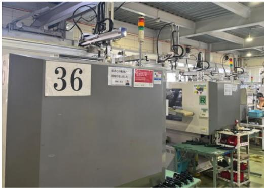
同社は中核技術となる射出成形に関して、20トン～300トンクラスの多様なサイズの射出成形機を取り揃え、また射出成形機の種別に関しても電動機からハイブリッド機まで製造する製品に応じた多様な種別を取り揃えることで、製造する製品によって使い分け高品質かつ効率的な製品製造を実現している。
